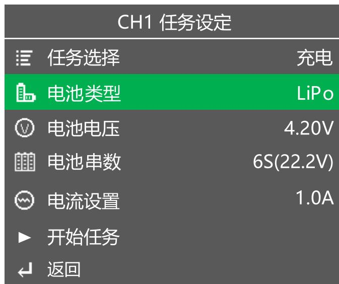
将电源与充电器AC或DC口连接，等待系统自检完成，在待机界面下，将电池连接好充电器，选择相应通道后，短按OK键 即弹出“任务设置”菜单；
